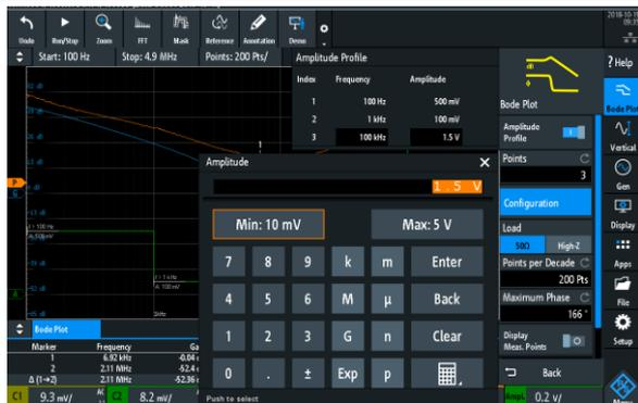
在测量控制环路频率响应或PSRR电源抑制比时，用户可以改变内置信号源的幅度输出电平，以抑制DUT的噪声特性，有助于提高信噪比
