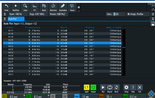
测量结果表提供了每个测量点的详细信息（频率、增益和相移）。使用标记时，将结果表的相关行高亮显示。屏幕截图和表格结果可快速保存到U盘
