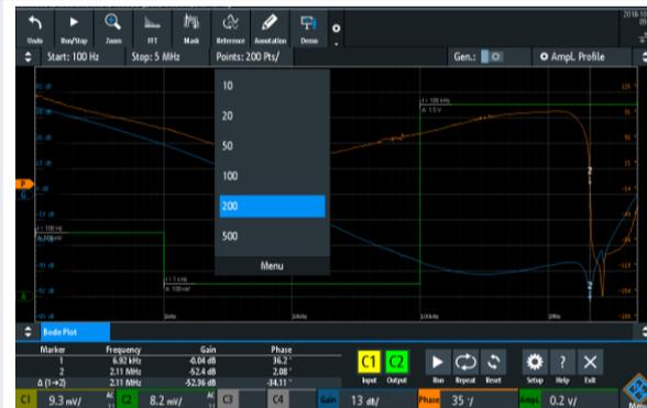
通过设置十倍程点数来调整波特图的分辨率。示波器每十倍程最多支持500个点。可将标记直接拖动到图上的所需位置，轻松确定相位和增益裕度
